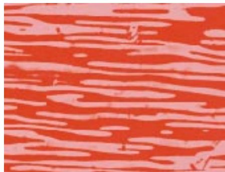
Рис. 4. Фотография доменной структуры сегнетоэлектрического триглицинсульфата после охлаждения через точку Кюри ( T_c = 49^\circ )
